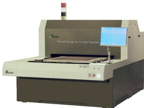
레이저 직접 제판 시스템 DIS300 Computer to Screen System
